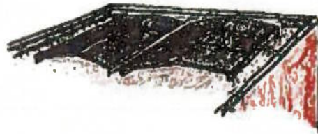
PV-Module auf Flachdach mit Attika
