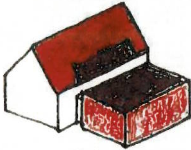
PV-Module in West-Ost Ausrichtung mit 10° und unter der Attika in Kombination mit „Traufenmodulen“
