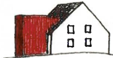
PV-Module vom Flachdach auf restl. Dachfläche erweitert. Restfläche mit gleichfarbigem Falzblech.
